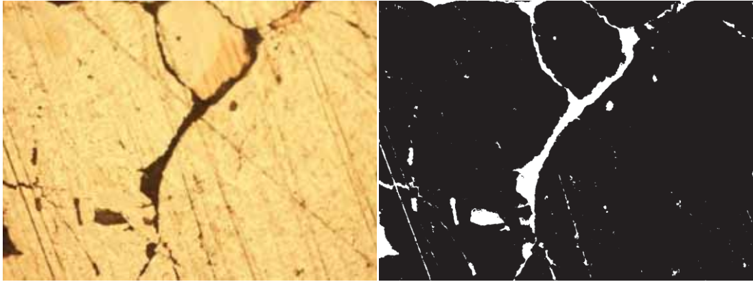
圖 4.19 NO.19 孔隙率為 5.12%
