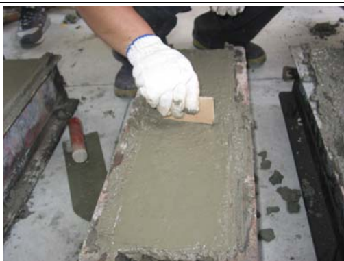
用瓦楞紙製造表面裂縫
