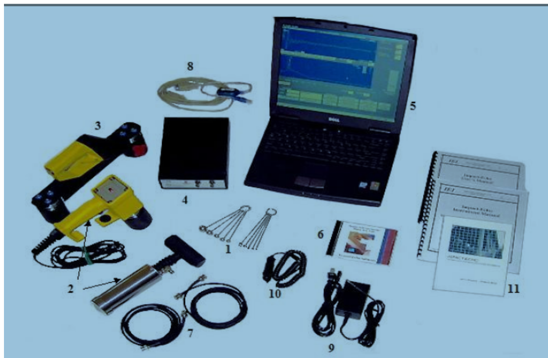
圖 2-4 敲擊回音儀器及配件圖
