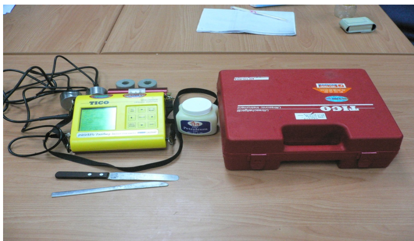
圖 2-14 超音波儀器及配件圖
