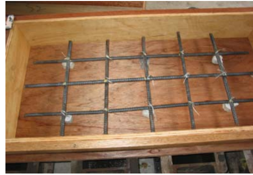
S1 鋼筋放置於模版中 保護層 50mm
