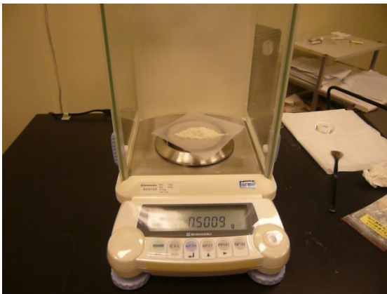
圖 11 以分析天平量測樣品圖
