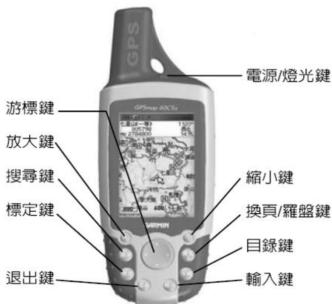
圖 4.1 Garmin GPSmap 60CSx 實體操作介面分佈情況
