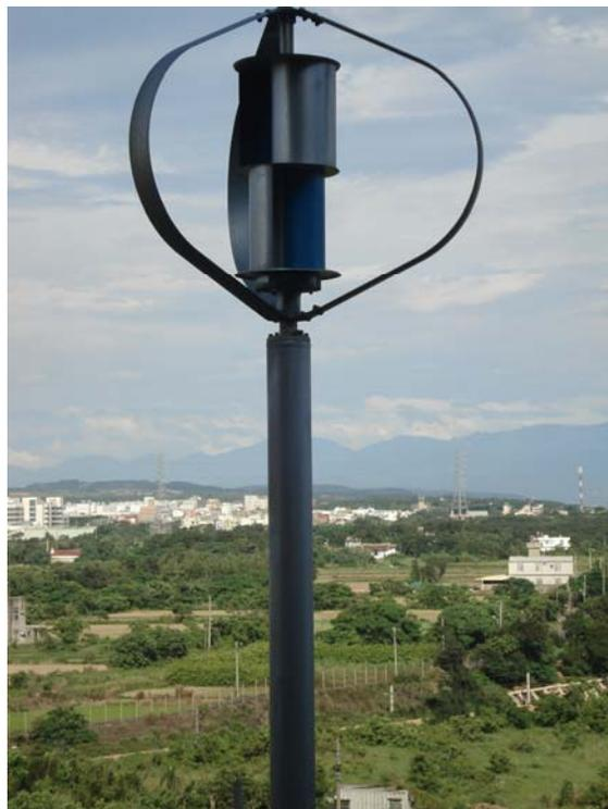
圖 2.5 垂直軸風力發電機
