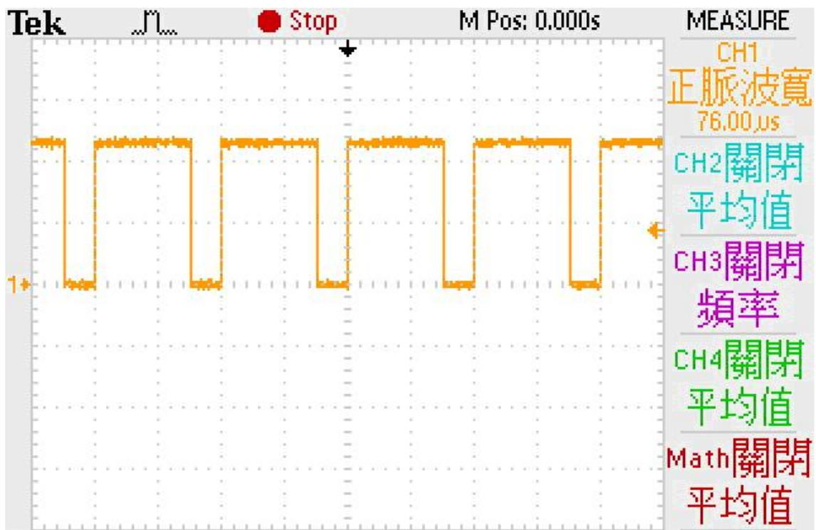
圖 4.19 風扇電壓 85V，最大功率追蹤輸出責任週期
