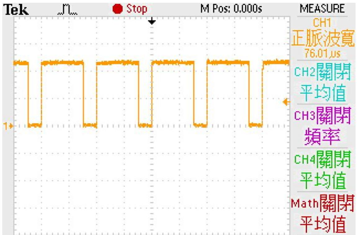
圖 4.21 風扇電壓 110V，最大功率追蹤輸出責任週期
