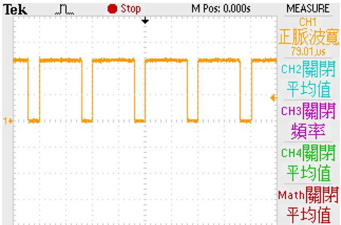
圖 4.17 風扇電壓 70V，最大功率追蹤輸出責任週期
