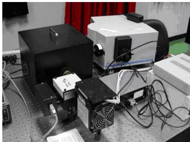
包含光源、單光儀、樣品箱、光偵測器等部分組成的螢光影像光譜儀系統。
