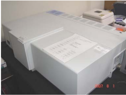
全光域 (UV/VIS/NIR) 分光光譜儀的外觀；圖右：光譜儀的樣品箱內部。
