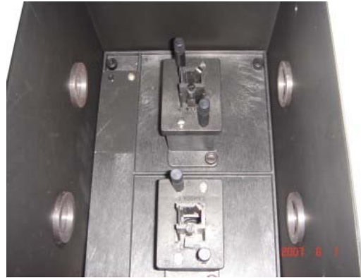
全光域 (UV/VIS/NIR) 分光光譜儀的外觀；圖右：光譜儀的樣品箱內部。
