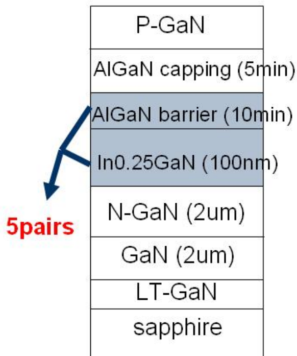
圖二十四 AlGaN 覆蓋層之氮化銦鎵磊晶結構(5 pairs)
