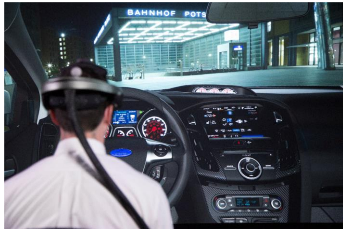
圖 8、使用者在福特廠中帶上虛擬實境裝置後，可透視觀看到汽車外的虛擬場景內容
