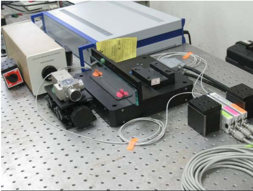
圖 6.壓電平台定位之實驗測試
