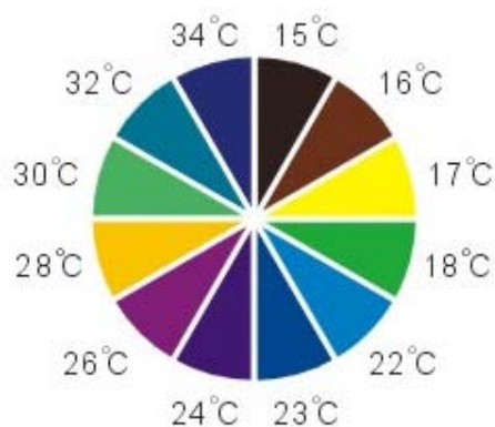
圖 14 液晶材料可逆性七彩顏色變化圖
