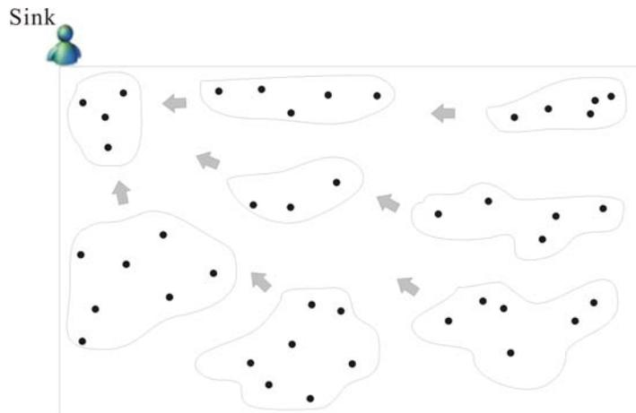
(d). Partitions 內的 Mobile Sensors 向 Sink 方向移動
