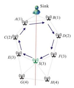
圖十.Risk Sensor S 將發起以 Right Hand Rule 為傳送方式的偵測封包
