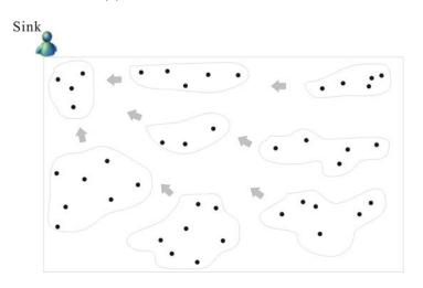
(d). Partitions 內的 Mobile Sensors 向 Sink 方向移動
