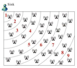
圖八.網路初始化後,所有 Mobile Sensors 將可得到自己與 Sink 的最短距離
