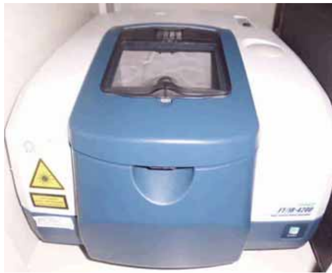
圖 3.10 傅立葉轉換紅外線光譜儀(FT-IR)
