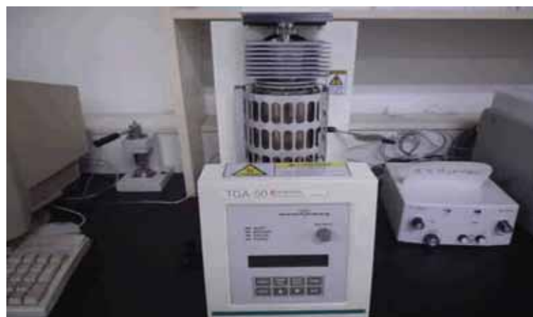
圖 3.9 TGA-50 熱重分析儀
